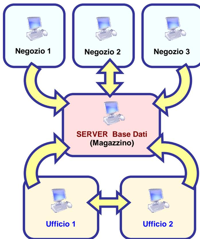
Lo schema della figura, descrive un semplice impianto costituito da un Server, tre negozi e due postazioni di lavoro di ufficio. I negozi possono essere dislocati ovunque sia possibile arrivare con una connessione internet ADSL. Nel caso di piccole attività composte da un solo negozio e un solo magazzino, il server, il negozio ed il programma di magazzino possono essere installati nello stesso PC.
